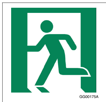
Figure A-3.4.5.1. 2)c)-A « Issue de secours à gauche » (E001), symbole extrait de la norme ISO 7010
